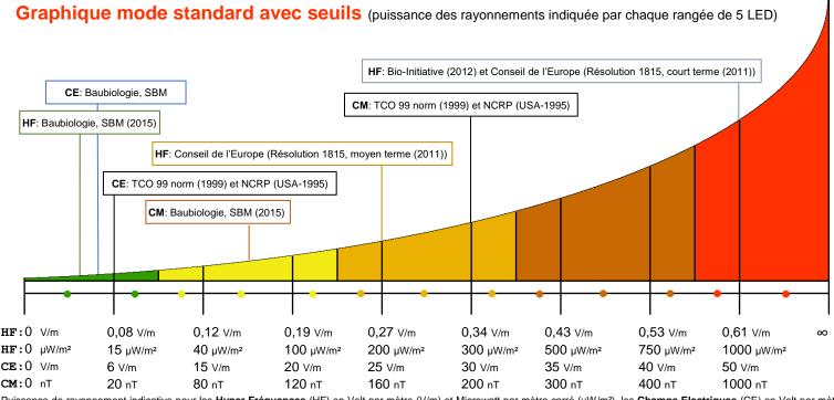
Puissance de rayonnement indicative pour les Hyper Fréquences (HF) en Volt par mètre (V/m) et Microwatt par mètre carré (µW/m²), les Champs Electriques (CE) en Volt par mètre (V/m) et les Champs Magnétiques (CM) en Nanotesla (nT), suivant la couleur des LED allumées. Les seuils indiqués ci-dessus sont des recommandations et des normes provenant des sources correspondantes (voir ci-dessous).
